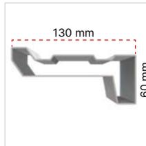
Rahmengestell aus 1,5 mm starkem Stahlblechprofil, Querschnitt 130×60 mm.
